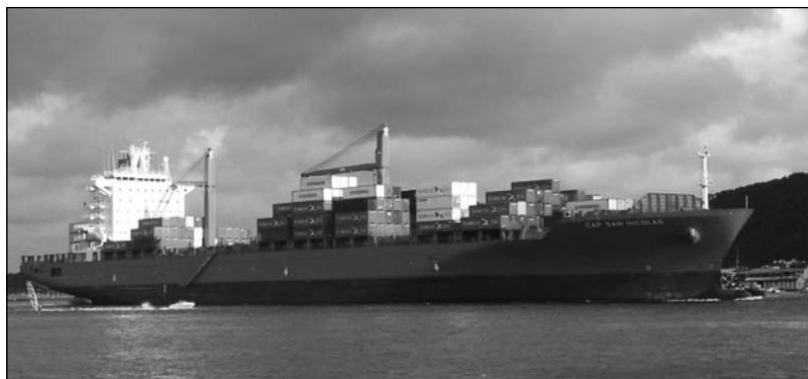
Figura 10. Portacontenedores “CAP SAN NICOLÁS” de la noviera Hamburg Süd; un buque que con sus 332m de Eslora, 48,2m de Manga, 14m (46) de Calado y capacidad para 9600 TEU’s excede por mucho y notablemente las capacidades de los canales de aproximación, radas de espera, antepuerto e instalaciones portuarias de Buenos Aires. Por ese motivo no puede entrar a puerto a Plena Carga.
